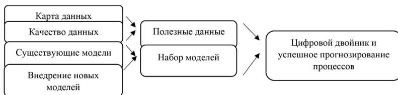
Рис. 3. Типичная схема создания цифрового двойника [8]
