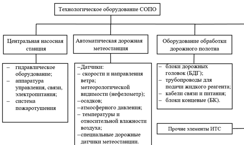
Рис. 2. Схема технологического оборудования СОПО
