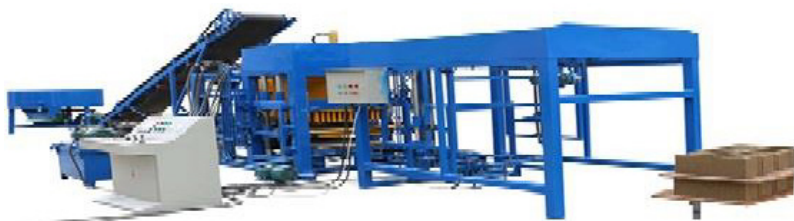
Рис. 1. Установка для формирования железобетонных вентиляционных блоков
