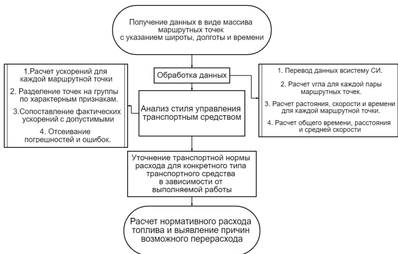
Рис. 2. Алгоритм работы с данными, полученными системой спутникового мониторинга
